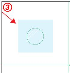
③ Fensterhinterklebung mit PLA oder Cellulose Folie. Das Produkt kann schon vor dem öffnen geprüft werden.
